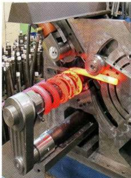
Maschinen der Baureihe „WIM CNC“ fertigen Zug-, Druck- und Drehfedern warm und kalt sowie rechts und links gewickelt. Bild: Fortuna Federn
